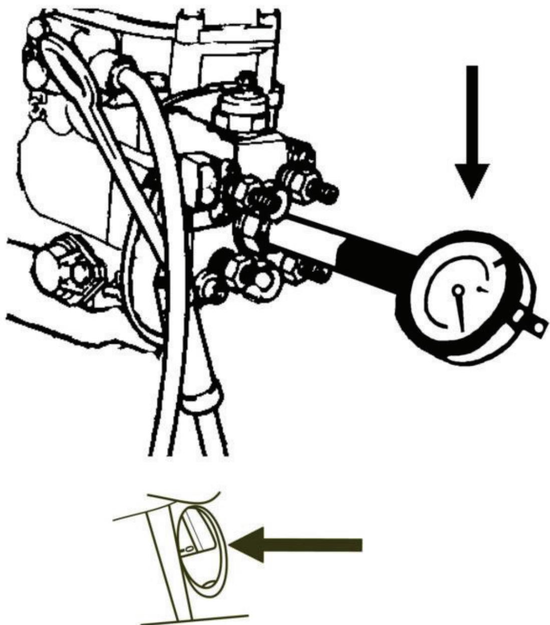
Cyl. 1 i kompr top. Måleur i pumpe. Krumtap drejes modsat omdrejningsretning til måleur ikke længere giver udslag. Måleur nulstilles. Drej krumtap til topmærke og aflæs måleur (se tekniske data).
